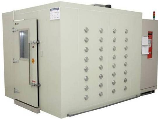
巨型溫濕度測試設備
